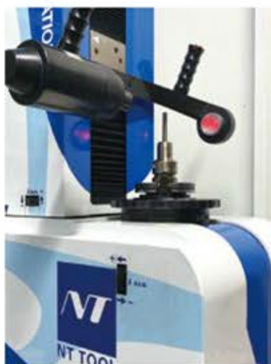
友新精機の現場で稼働するツールプリセッター「AOTP型」(左)とエヌティーツールのツールホルダー
